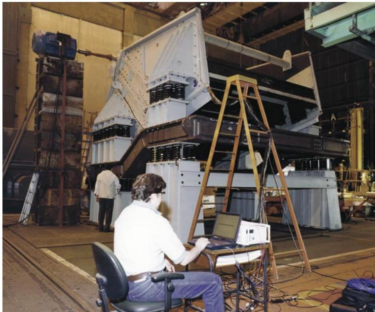
Tension analysis in a test at the manufacturing premises / Análisis de tensiones durante teste en la planta
