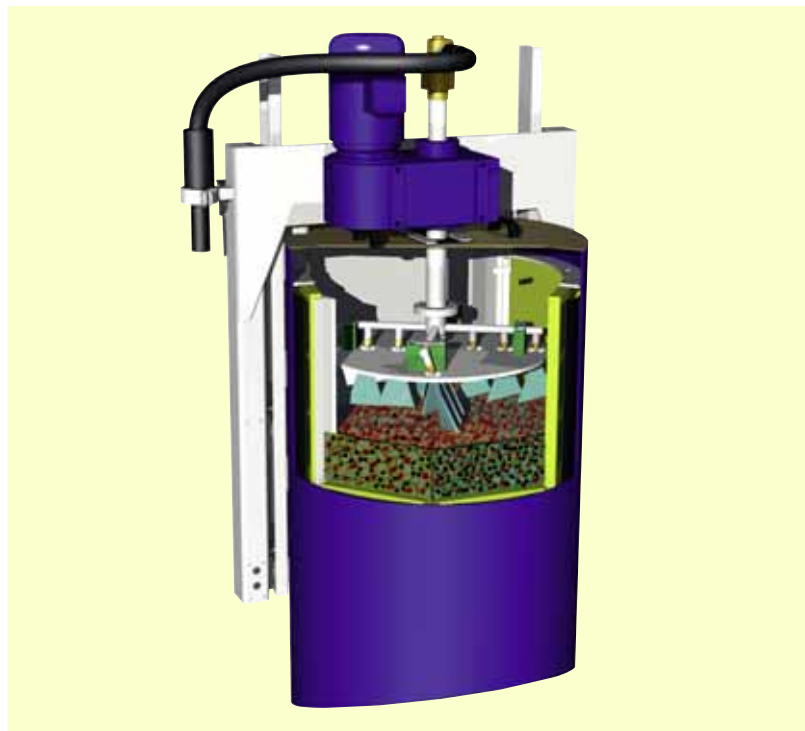
Vista de la sección del recipiente de lavado
