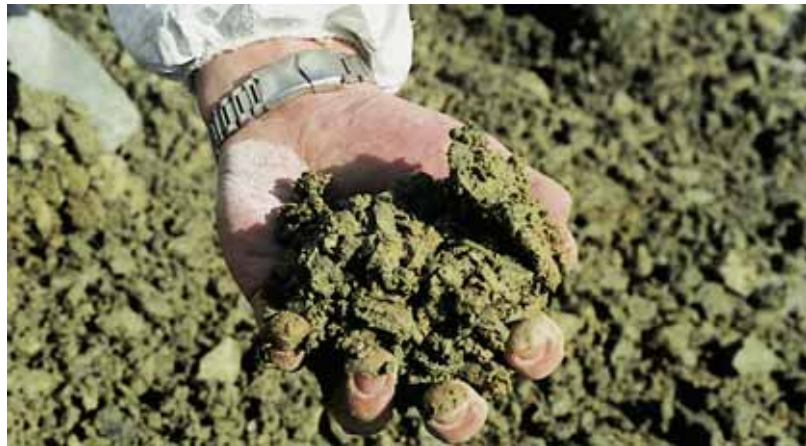
Material pedregoso contaminado con suciedad
