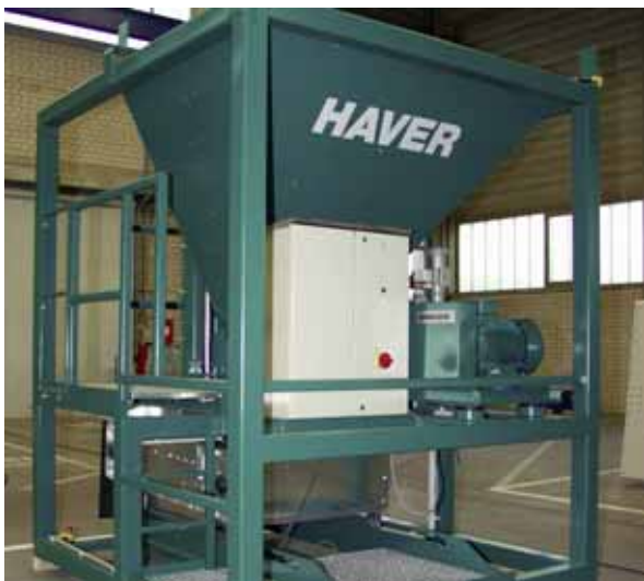
Módulo HAVER-Hydro-Clean con bomba y cabina de contactos integrados
